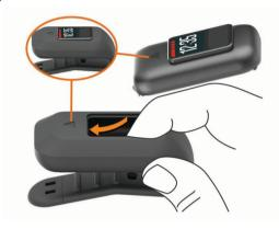
Entfernen Sie das Gerät aus dem Gürtelclip, indem Sie beide Seiten des Gürtelclips in die Hände nehmen und den Gürtelclip in entgegengesetzte Richtungen drehen. Entnehmen Sie das Gerät, indem Sie den Clip um das Gerät ein wenig ziehen und formen.
