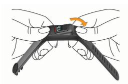
2 Setzen Sie das Gerät in den flexiblen Silikonclip ein. Dabei müssen Sie den Clip ein wenig ziehen und formen, bis er um das Gerät passt.
