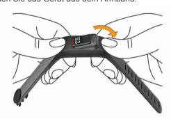
2 Setzen Sie das Gerät in das flexible Silikonband ein. Dabei müssen Sie das Band ein wenig ziehen und formen, bis es um das Gerät passt.
